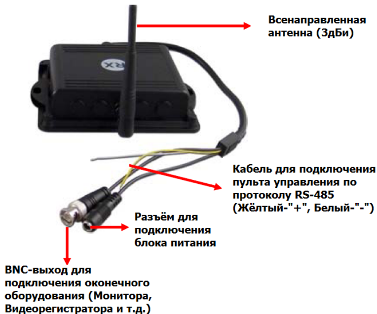
Рис.5 Панель подключения WR2.4/5(W).
