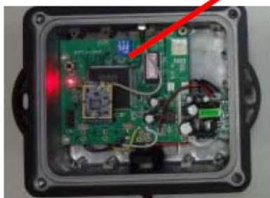
Рис.8 Расположение DIP-переключателя внутри устройства.
