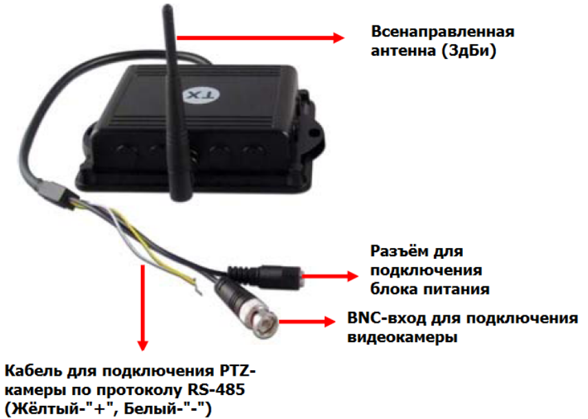
Рис.4 Панель подключения WT2.4/5(W).
