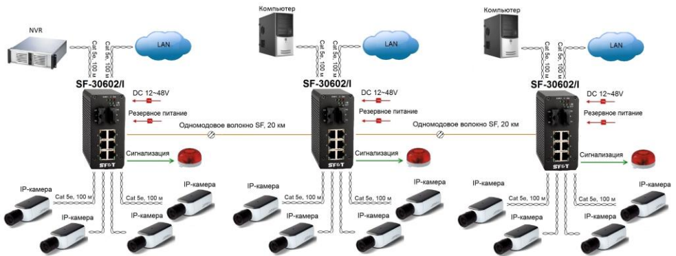
Рис.6 Схема подключения трех коммутаторов SF-30602/I
