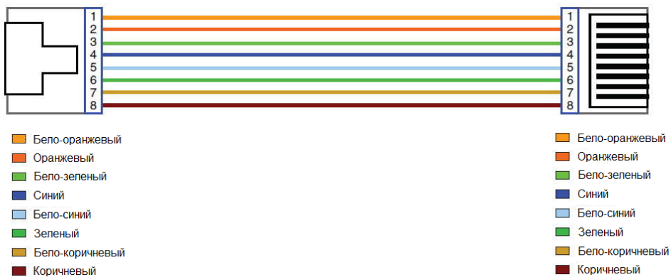
Рис. 8 Разводка кабеля по типу TIA/EIA-568-A.
