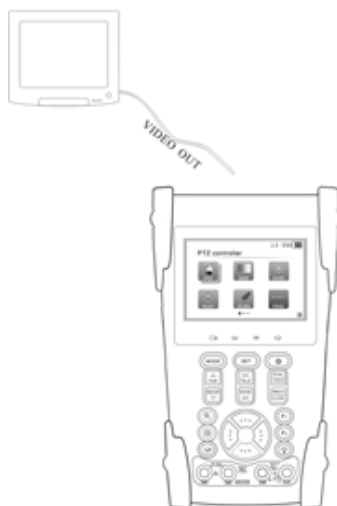
Рис. 12 Подключение к тестеру монитора.
