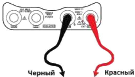
Рис.3 Подключение измерительного щупа к тестеру.
