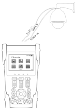
Рис. 8 Подключение к тестеру PTZ-камеры.
