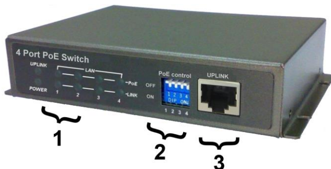
Рис.2. Коммутатор SW-20500/C , вид спереди
