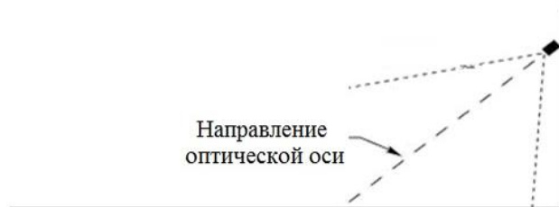
Рисунок 4 – Рекомендуемая установка термокожуха по отношению к горизонту
