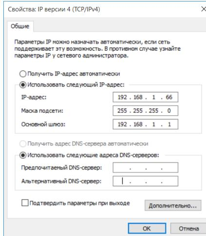
В поле IP-адрес ввести адрес одной подсети с IP-камерой. Например, если камера имеет IP-адрес 192.168.1.66, то сетевому адаптеру ПК можно назначить IP-адрес, к примеру, 192.168.1.1, маска подсети по умолчанию 255.255.255.0.
