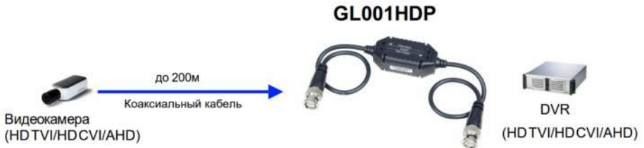
Рис. 3 Схема подключения GL001HDP
