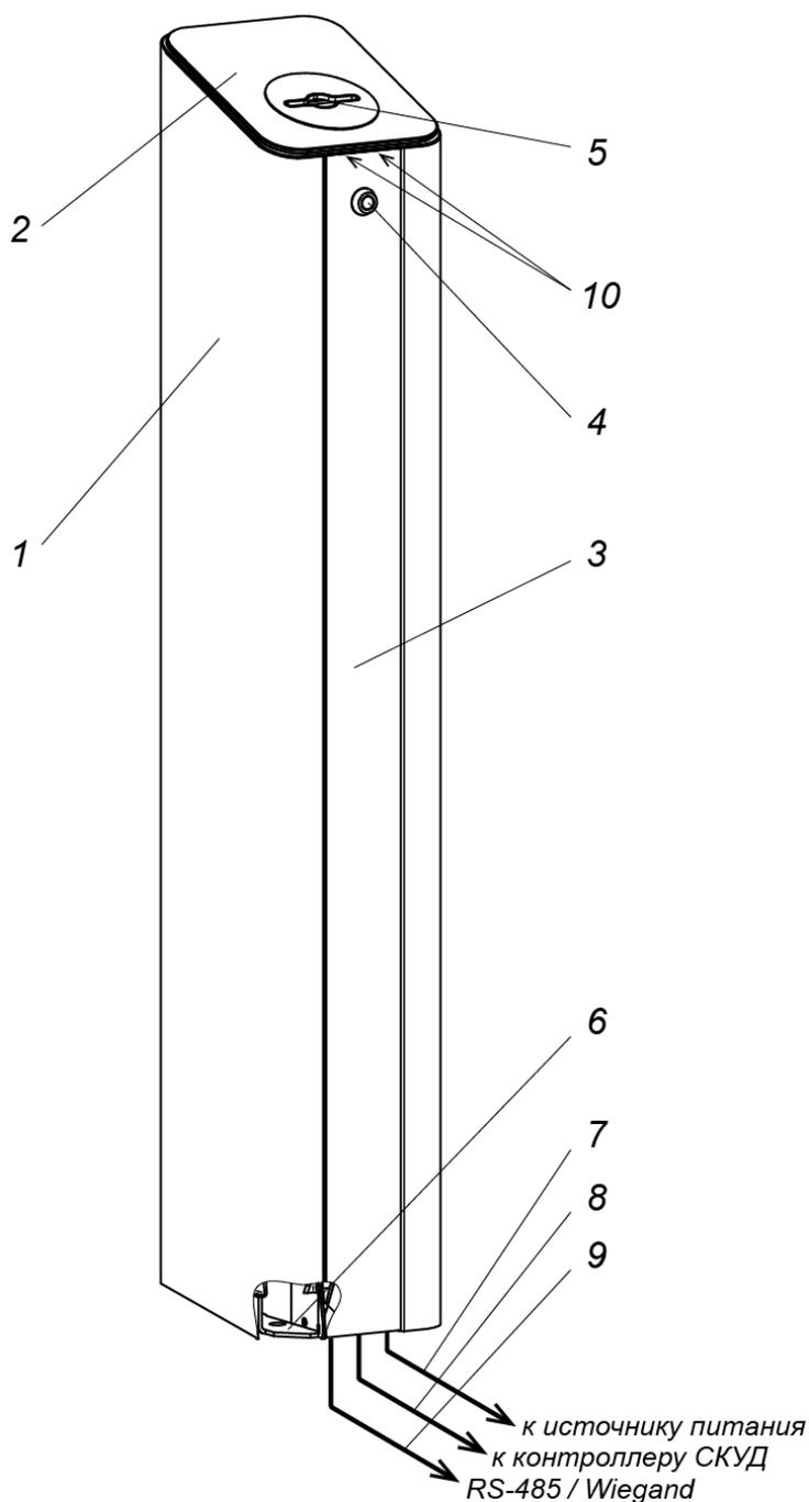
**Рисунок 2. Устройство картоприемника:**
