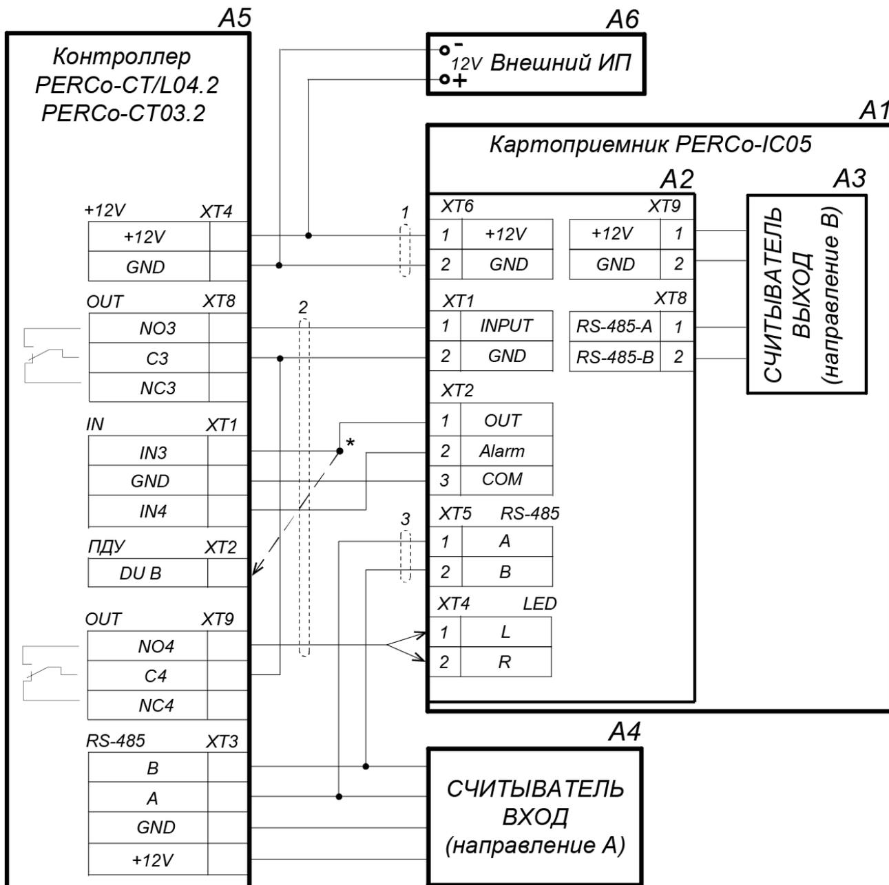
\* Если все дополнительные входы контроллера заняты, то выход картоприемника «Карта изъята» подключается параллельно ПДУ ко входу управления контроллера DU B (или DU A в зависимости от направления прохода).
