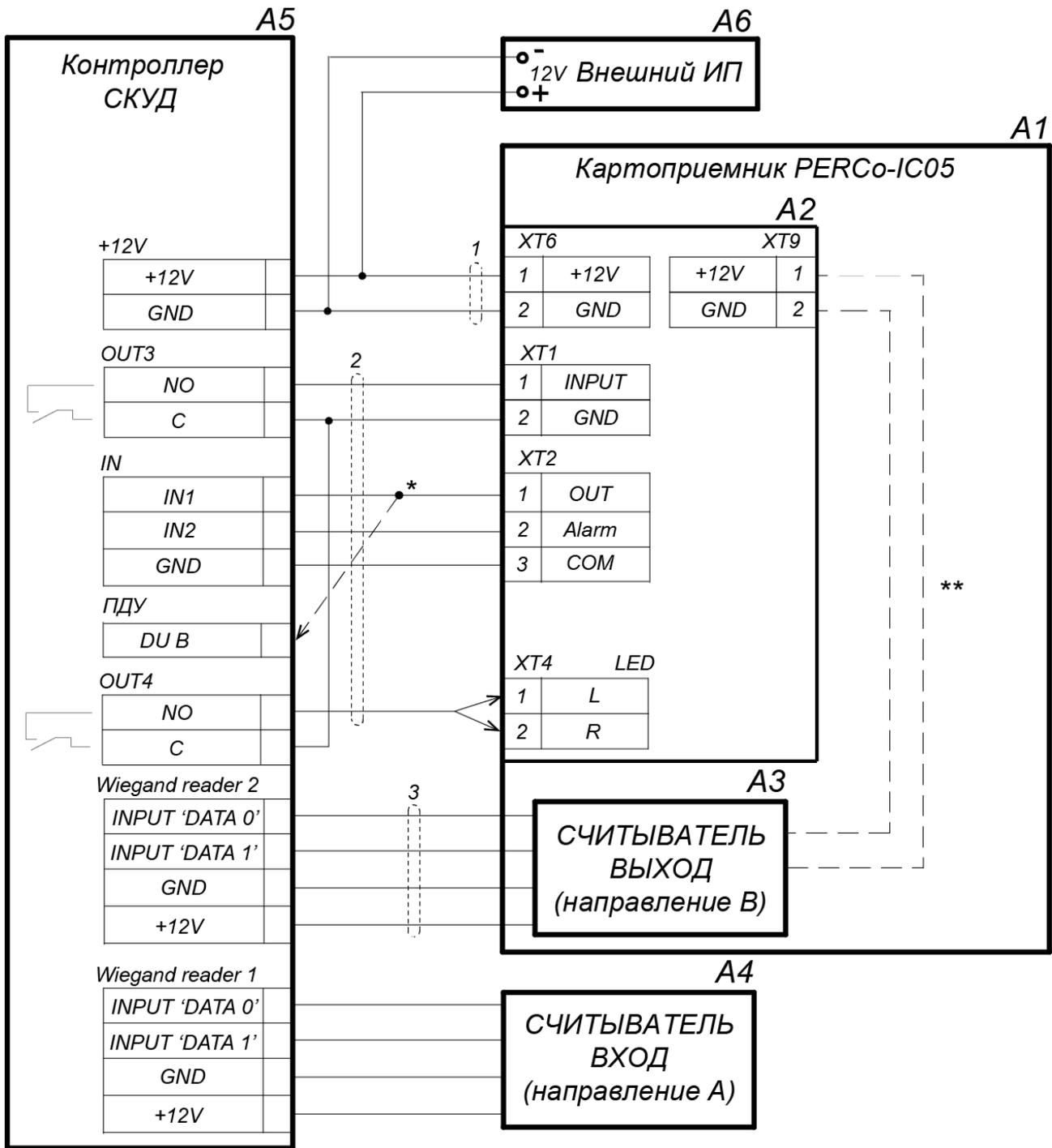
\* Если все дополнительные входы контроллера заняты, то выход картоприемника «Карта изъята» подключается параллельно ПДУ ко входу управления контроллера DU B (или DU A в зависимости от направления прохода).
