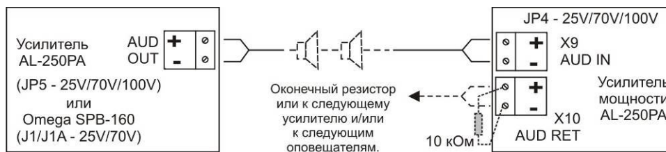
Рис.7г Пример подключения к аудио выходу другого усилителя AL-250PA или Omega SPB-160. Усилитель AL-250PA работает в режиме «Зональный» (см. п.4.2)
