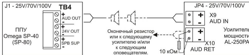
Рис.7в Пример подключения к ППУ Omega SP40/2 (SP-80). Усилитель AL-250PA работает в режиме «Зональный» (см. п.4.2)
