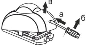
**2** Отогнуть зацеп на основании. Снять плату
