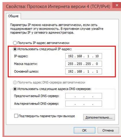
В поле IP-адрес ввести адрес одной подсети с IP-камерой. Например, если камера имеет IP-адрес 192.168.1.10, то сетевому адаптеру ПК можно назначить IP-адрес, к примеру, 192.168.1.1, маска подсети по умолчанию 255.255.255.0.
