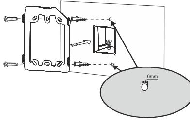
1. Скрытая проводка: зафиксируйте кронштейн на соединительной коробке, которая уже установлена в стене.
