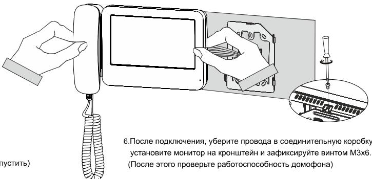
6. После подключения, уберите провода в соединительную коробку, установите монитор на кронштейн и зафиксируйте винтом M3х6.
