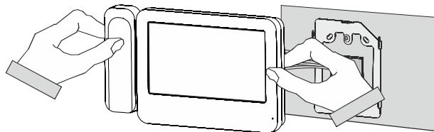
4. После подключения шлейфа проводов, установите монитор на кронштейн.
