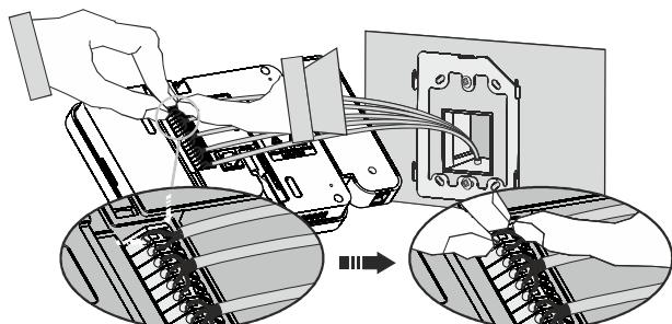
3. Подсоедините каждый провод к разъему, проверьте надежность соединения.
