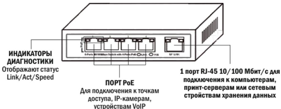
Индикаторы позволяют обнаружить и выявить всевозможные проблемы коммутатора и подключенных устройств.
