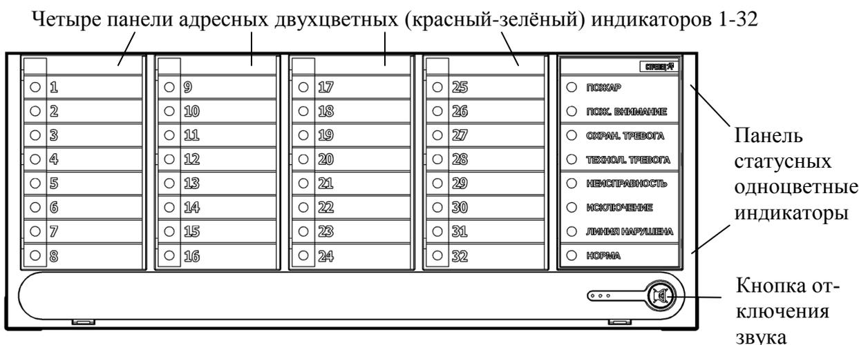
В правом нижнем углу имеется кнопка "Звук", предназначенная для отключения звуковой сигнализации до появления нового события.
