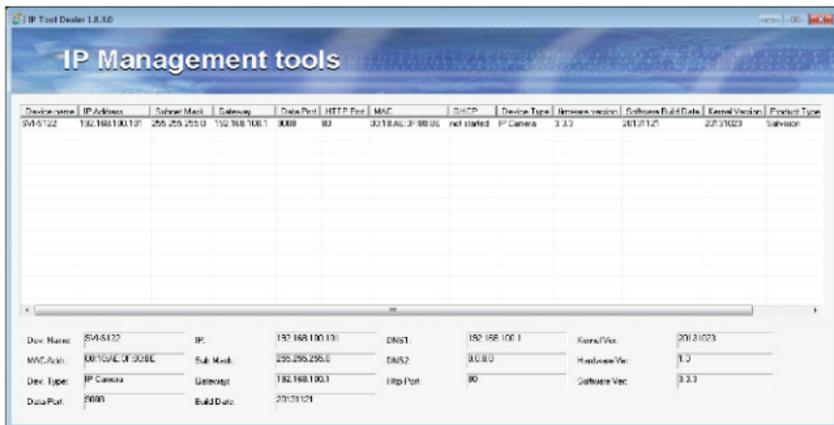
IPTool сканирует вашу сеть на наличие подключенных IP-камер. Выбрав нужную вам IP-камеру, щелкните правой кнопкой мыши на ней в строке программы IPTool и выберите пункт «network setup»:
