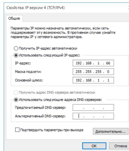
В поле IP-адрес ввести адрес одной подсети с IP-камерой. Например, если камера имеет IP-адрес 192.168.1.66, то сетевому адаптеру ПК можно назначить IP-адрес, к примеру, 192.168.1.10, маска подсети по умолчанию 255.255.255.0.
