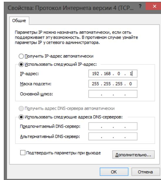
В поле IP-адрес ввести адрес одной подсети с IP-камерой. Например, если камера имеет IP-адрес 192.168.0.123, то сетевому адаптеру ПК можно назначить IP-адрес, к примеру, 192.168.0.1, маска подсети по умолчанию 255.255.255.0.
