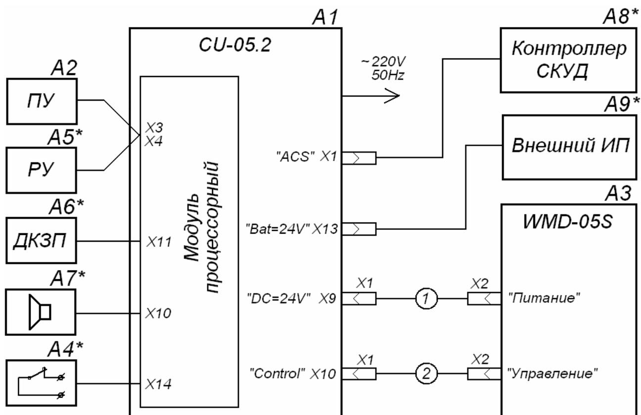
Рисунок Б.1 Схема подключения калитки
