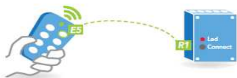
A-1a Привязка передатчика к приемнику
