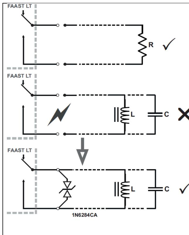
Подключение индуктивной нагрузки
