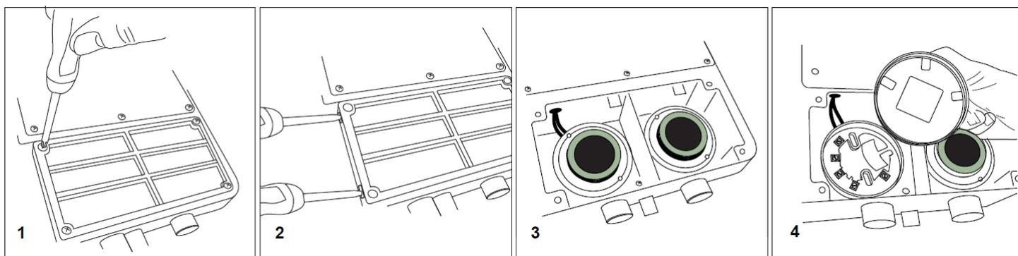
Поверните датчик против часовой стрелки, чтобы снять его с базового основания. Не меняйте дымовые извещатели местами и не меняйте положения поворотных переключателей адреса на них. При необходимости замены дымового извещателя используйте только F-SEN-SSE.
