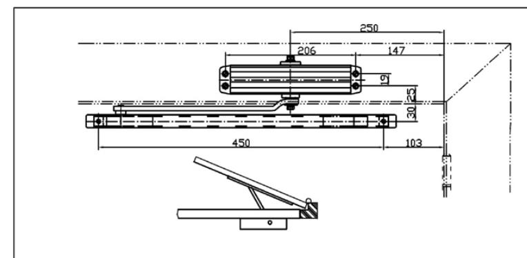
**ВНИМАНИЕ!!!** Нарушение правил эксплуатации может привести к выходу из строя доводчика, в частности к вытеканию масла и поломке штанги. К этому приводит: длительная блокировка двери в открытом положении либо излишнее усилие, прикладываемое к двери в момент ее закрывания.
