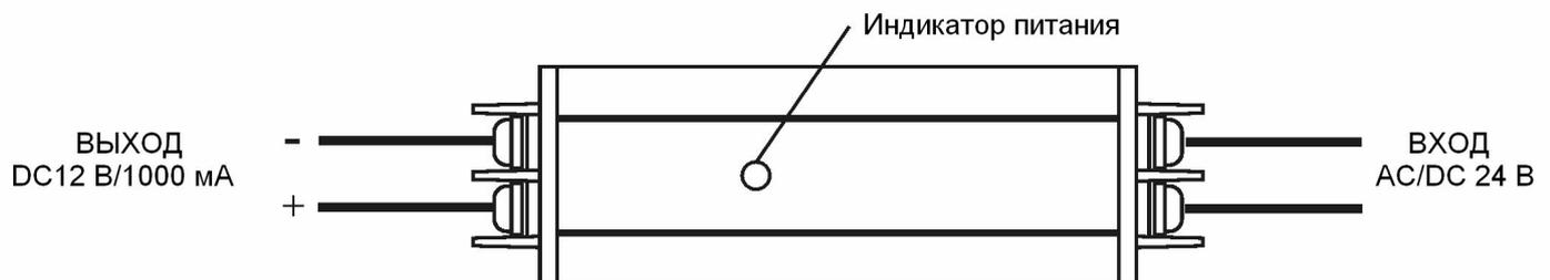
Рис.3 Схема подключения
