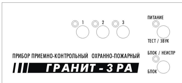
Рисунок 1.3 – Внешний вид панели индикации и управления прибора «Гранит-3РА»
