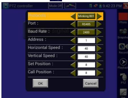
Рис.3.3.1-2 Окно настройки протокола управления камерой (RS485)
