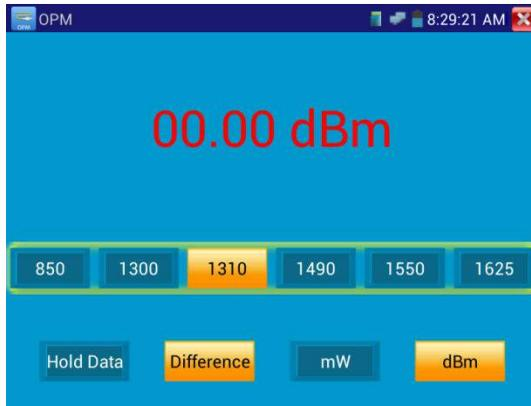
Рис. 3.3.12-1 Измерение относительной оптической мощности
