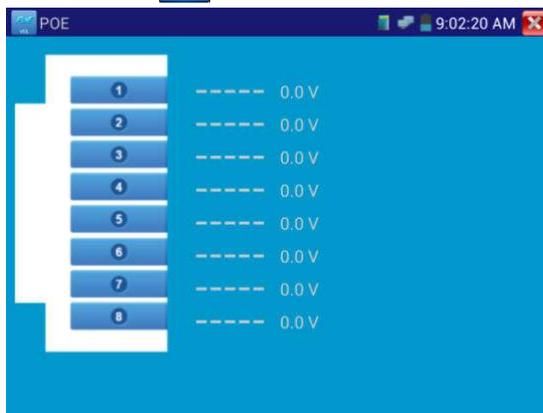
Рис. 3.3.18-1 Напряжение PoE на линиях кабеля витой пары
