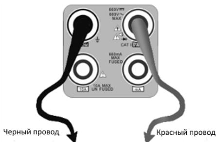
Рис.3.1-1 Подключение измерительного щупа к тестеру.
