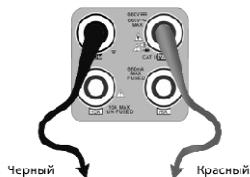
Ручная установка диапазона измерений: (замкните красный и черный щупы между собой, на дисплее отобразится текущий диапазон)
