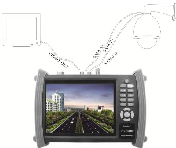
Рис.3.2.2-1 Подключение к тестеру PTZ-камеры и монитора.
