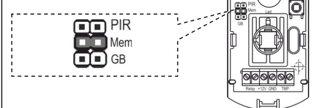
**12** Подать питание на извещатель и включить режим "Тест АК - канала", сняв перемычку с вилки Mem (таблица 2). Режим включается на 8 мин
