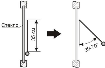
3) если на извещателе при нанесении тестового удара происходит выдача извещения "Высокочастотная помеха" или "Тревога - АК", его следует считать настроенным;
