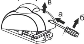
**2** Отогнуть зацеп на основании. Снять плату
