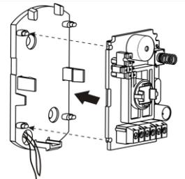
**10** Закрепить подведенные провода в клеммах извещателя
