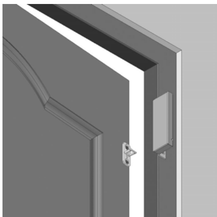
Рис.3 Установка замка на монтажный L- уголок
