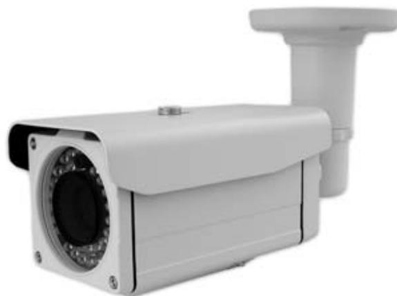
600/700 ТВЛ при освещенности до 0.15/0.001 лк в цветном/черно-белом режиме. В условиях пониженной освещенности может быть задействована функция цифрового шумоподавления (SSNR III).
