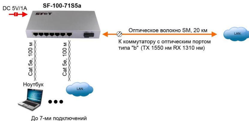
Рис. 4. Схема подключения коммутатора SF-100-71S5a
