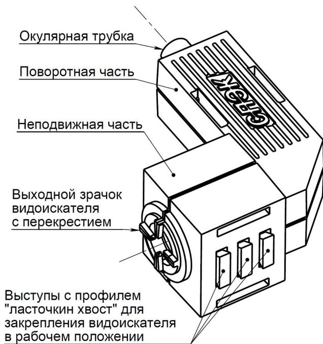
**Установка видоискателя и индикатора в рабочее положение**
