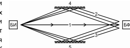
Похожий эффект может проявляться при наличии на улице дымки, измороси, легкого дождя, снега, особенно при установке БИ и БФ на дальностях более 75 м. В этом случае роль отражающих поверхностей 4 и 5 играют взвешенные в атмосфере частицы пыли, воды, снега.
