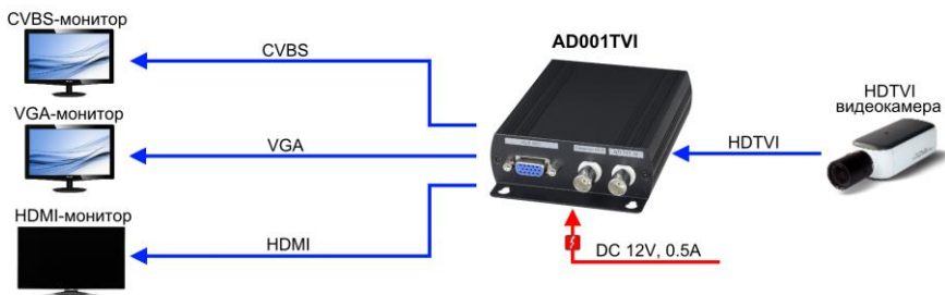
Рис.6 Схема подключения преобразователя-разветвителя AD001TVI
