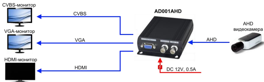
Рис.5 Схема подключения преобразователя-разветвителя AD001AHD
