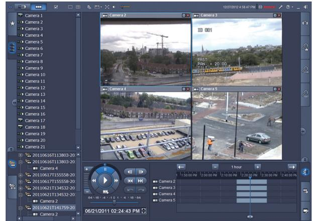
Консоль воспроизведения позволяет легко управлять прямым и обратным воспроизведением с низкой или высокой скоростью, применять видеопрокрутку и режим Trick Play к 4 источникам записи одновременно.
