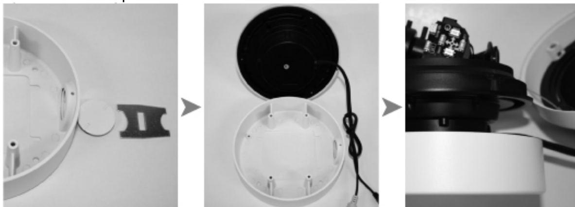
Сначала установите на поверхности монтажное основание
