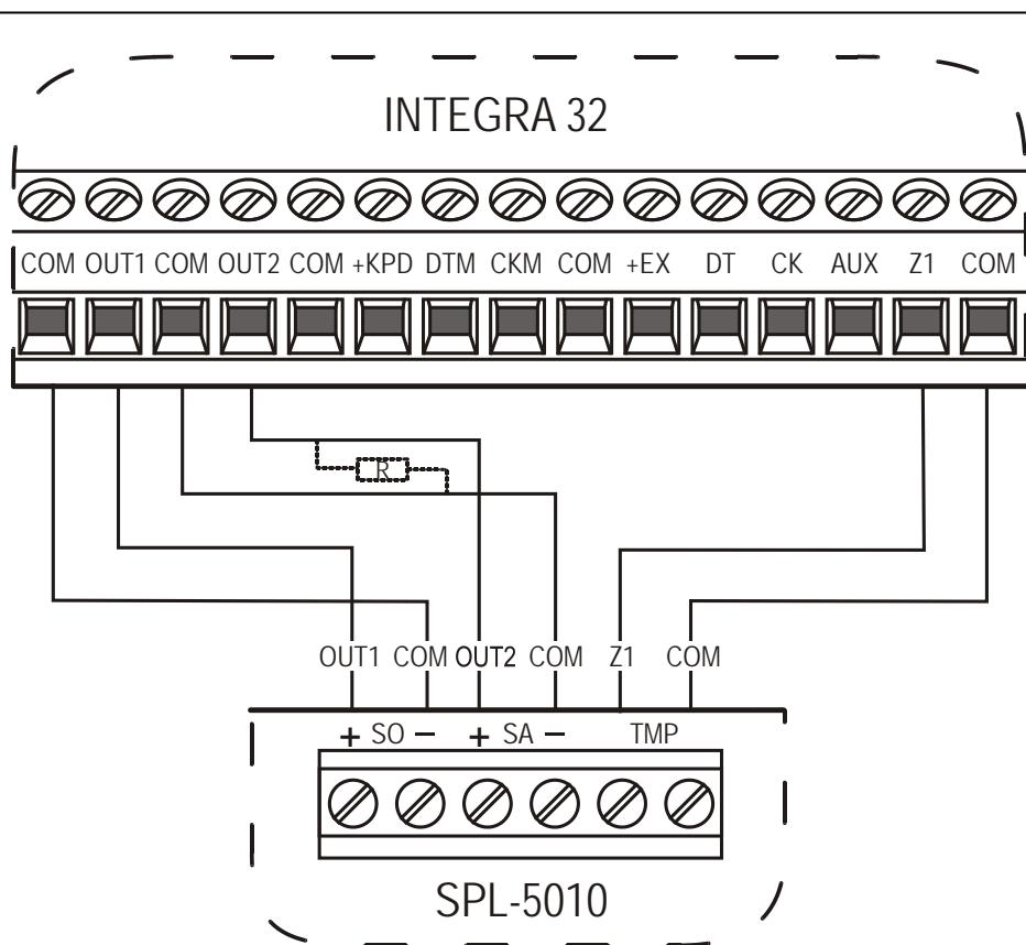
Рис. 2. Способ подключения SPL-5010 к силовым выходам ПКП INTEGRA 32.
