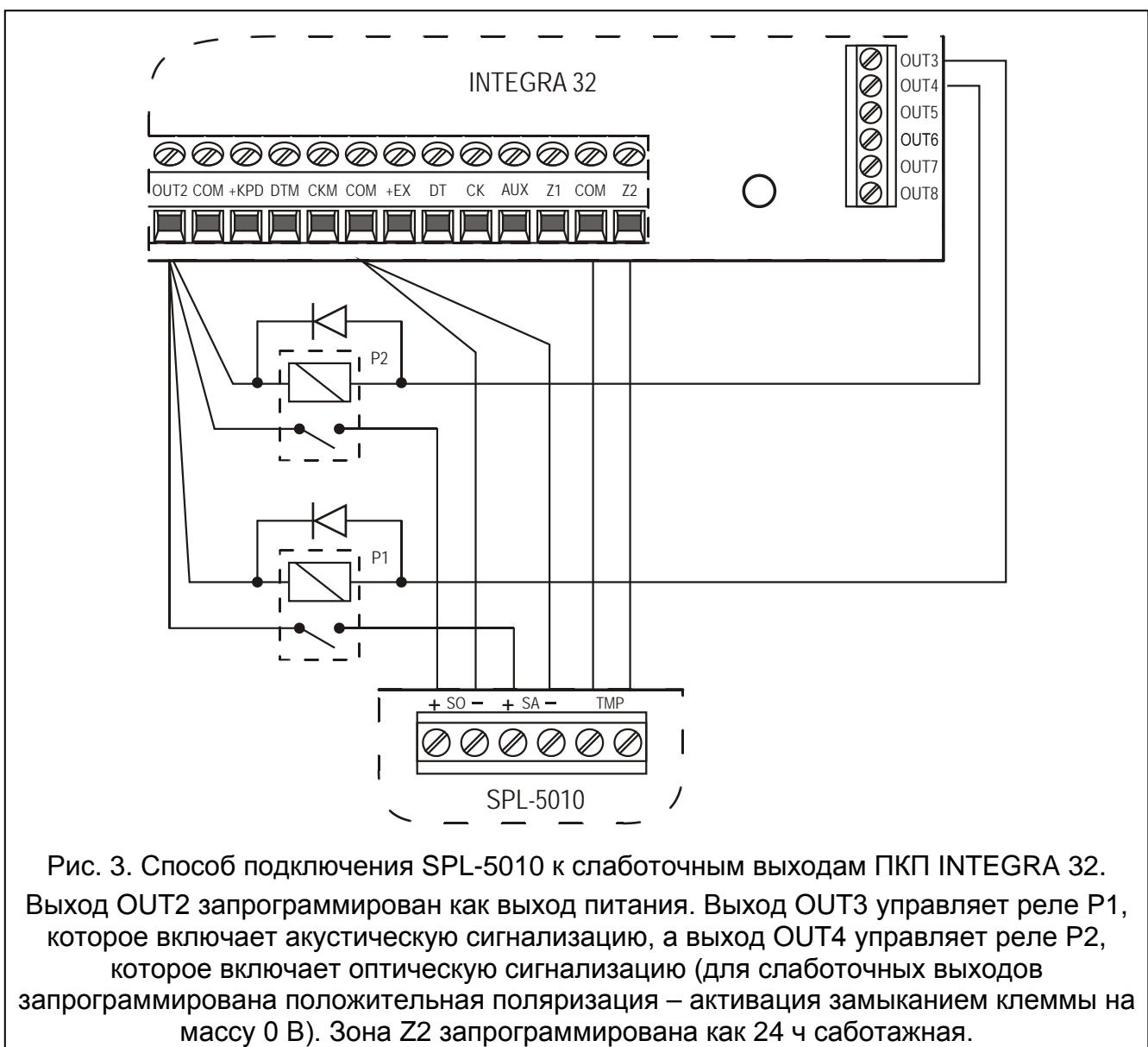
Рис. 3. Способ подключения SPL-5010 к слаботочным выходам ПКП INTEGRA 32.
