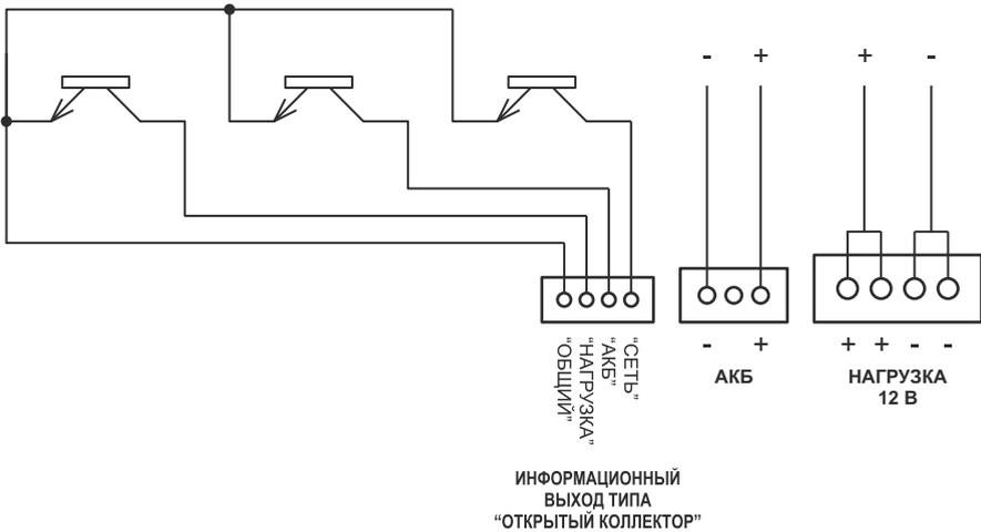
**Все выходы "открытый коллектор" работают относительно выхода "ОБЩИЙ" информационного разъема.**
