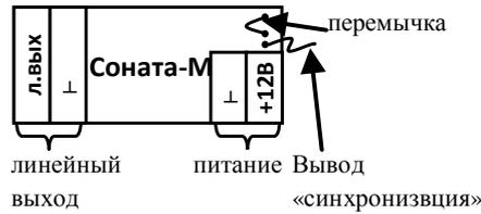
Рисунок – 1 Схема внешних соединений оповещателя «СОНАТА-М»
