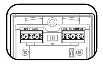
Контакт 1 - отмеченный "-" (GND) - Соединить с «массой» контрольной панели.
