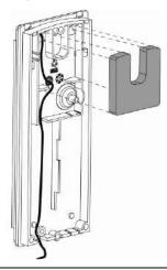
11. Установите основание детектора на кронштейн и зафиксируйте винтом.
