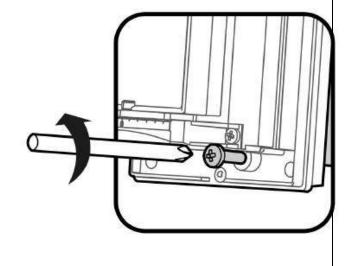
7. Снимите основание детектора с металлического кронштейна.
