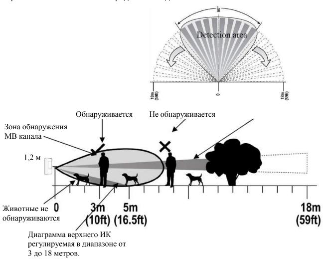
Благодаря наличию двух инфракрасных и микроволнового детекторов, EDS-3000 различает сигналы, генерируемые мелкими животными и человеком, и выдает сигнал тревоги корректно. Диаграмма направленности нижнего ИК имеет фиксированную дальность
