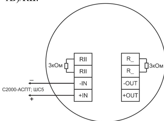
Рисунок 5 – Схема подключения УДП к С2000-АСПТ
