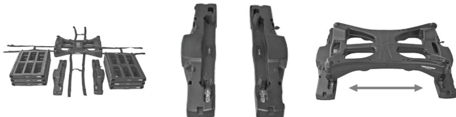
**2.** Установите вспомогательные опоры, расположенные на базовых блоках. Для этого потяните опору из основания до тех пор, пока она не начнет вращаться, затем поверните ее так, чтобы опора коснулась поверхности земли, и потяните еще до фиксации. Повторите это со всеми опорами.
