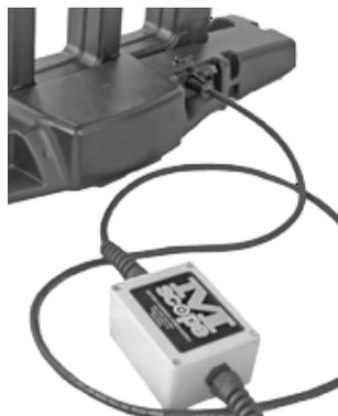
В каждом основании находятся аккумуляторные батареи. Вы можете подключить зарядное устройство к любому из двух оснований. При собранном металлодетекторе происходит одновременная зарядка обеих аккумуляторов. В противном случае каждую батарею необходимо зарядить отдельно.
