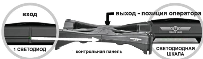
**Внимание:** неправильное расположение блока управления и панелей вызывает неисправность в работе устройства!
