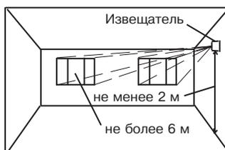
Рисунок 3 - Установка извещателя на боковой стене
