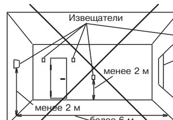
Рисунок 7 - Нерекомендуемые места установки извещателя
