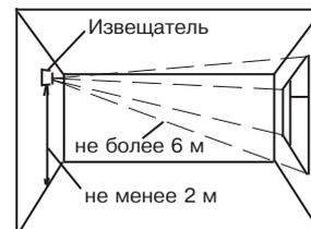
Рисунок 4 - Установка извещателя на противоположной стене
