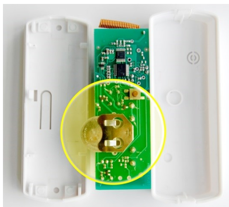
Рис. 8.3. Установка резервного элемента питания в радиоизвещатель Ладога-МК-РК
