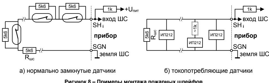
Рисунок 8 – Примеры монтажа пожарных шлейфов
