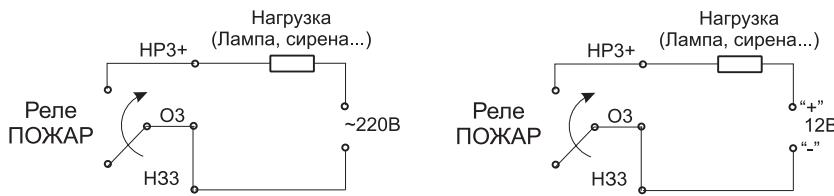
Рисунок 1 – Примеры подключения нагрузки к реле ПОЖАР
