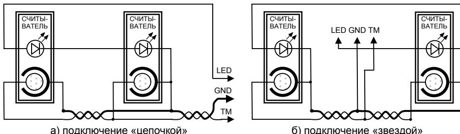
Рисунок 9 – Подключение двух считывателей
