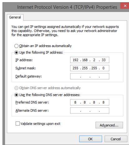
По умолчанию IP адрес коммутатора должен быть 192.168.2.1. Вы можете задать любой IP адрес в поле «IP адрес», в той же подсети что и IP адрес коммутатора. Нажмите кнопку OK, чтобы сохранить и применить настройки. Теперь вы можете использовать любой браузер для входа в меню настроек коммутатора.
