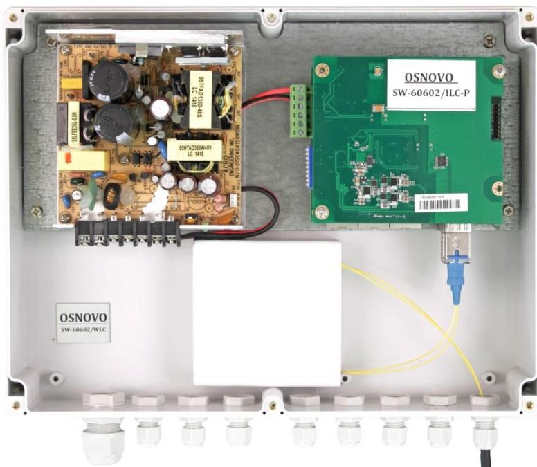
Рис.6.1 Коммутатор со смонтированным оптическим кросом
