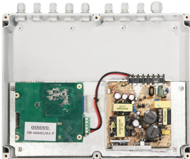
Рис.4.2 Коммутатор SW-60602WLC, вид со снятой крышкой бокса
