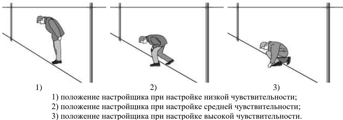
Рисунок 2.11 Способы имитаций преодоления 30 при приземном варианте установки.
