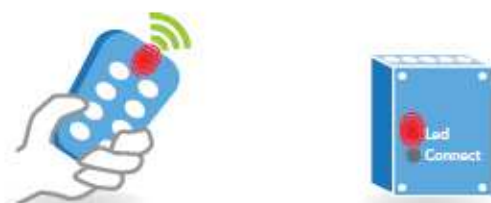
А-2а Светодиоды мигают, когда приемник получает команды от передатчика
