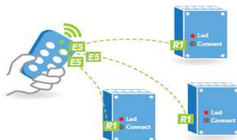
А-1b Подключение передатчика к 3 приемникам
