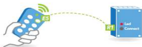
А-1а Привязка передатчика к приемнику
