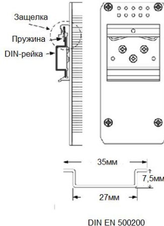
Рис.7 Монтаж коммутатора SF-G1041/I на DIN-рейку.
