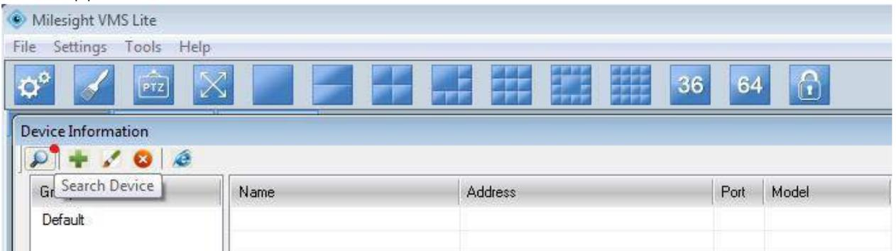
ПО «**Milesight VMS Lite**» самостоятельно проведет идентификацию портов подключения IP-камер, предложит ввести имя пользователя и пароль для доступа к обнаруженным камерам.
