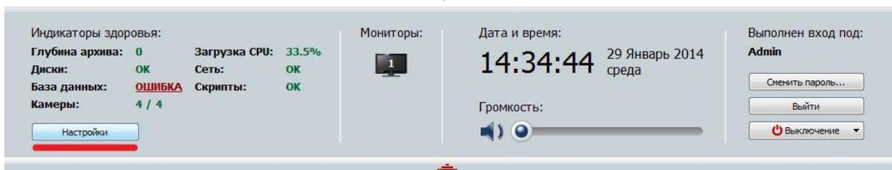
В окне «Настройка» необходимо пройти в закладку «Устройства» – «IP-Устройства». Нажать кнопку «Добавить вручную».
