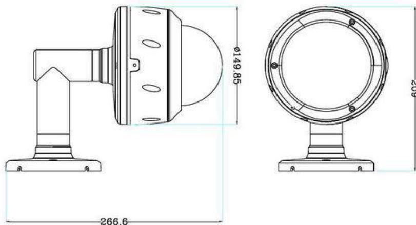
Монтаж видеокамеры необходимо производить на твёрдой устойчивой поверхности. Во избежание попадания влаги на разъёмы видеокамеры, рекомендуем использовать коммутационные коробки, со степенью защиты IP67.
