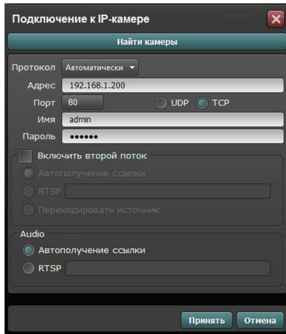
Далее нажмите на кнопку «Принять» и ожидайте некоторое время, несмотря на сообщение об отсутствии сигнала и невозможности применения настроек (до 1 минуты). Для примера на рисунке показан интерфейс ПО «Линия» с добавленной IP камерой BSP-DO50-VF-01.
