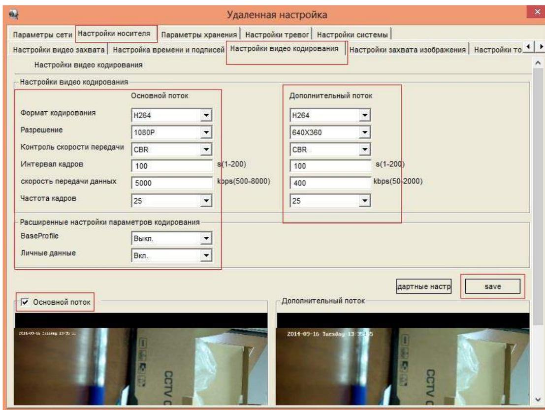
В окне «Настройки видео кодирования» при необходимости проведите настройки разрешения получаемого с камеры видео потока.
