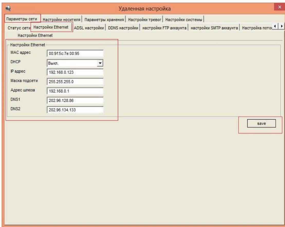
В окне «**Настройки Ethernet**» можно настроить сетевые параметры видеокамеры:
