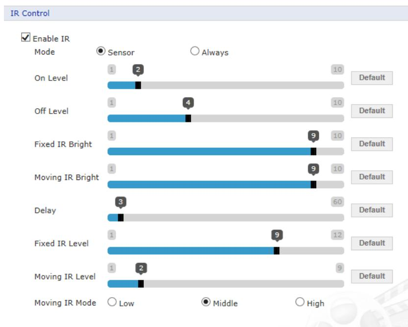
Данная камера оснащена неподвижной и подвижной ИК-подсветкой. Подвижная ИК-подсветка синхронизируется с оптическим масштабированием. В этой части пользователь может задавать параметры, связанные с ИК-подсветкой.
