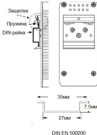
Рис.7 Монтаж коммутатора SF-G2041/IC на DIN-рейку.
