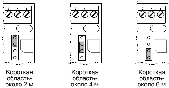
Рисунок 11. Установки переключателя зоны покрытия.
